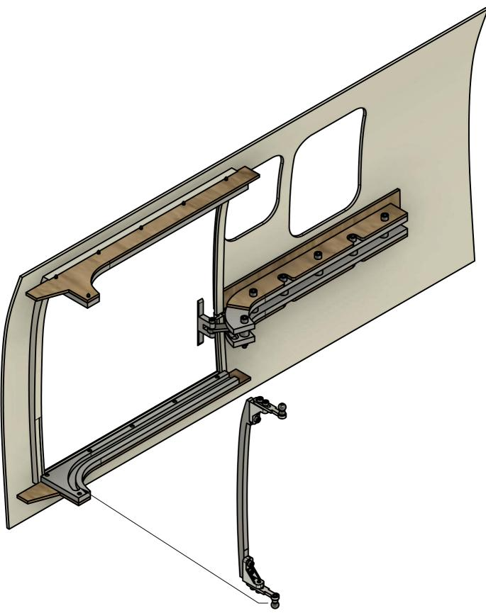
Die Kugelbolzen der Einheit in die untere und obere Laufnut einhängen.
