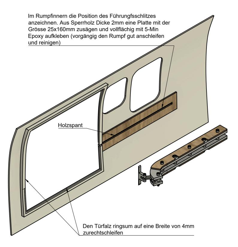
Nachdem das Sperrholzbrettchen aufgeklebt ist, den 3mm breiten Schlitz ausfräsen.
