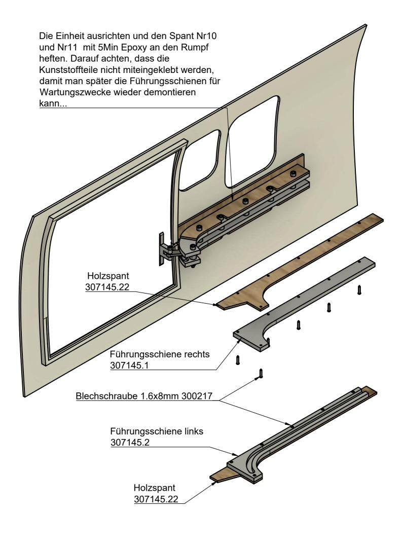
Damit die Schiebetüre einwandfrei funktionieren kann, ist es sehr wichtig, dass die Führungsschienen genau parallel und horizontal eingebaut werden. Hilfreich ist es, wenn man dazu einen digitalen Winkelmesser einsetzt oder wie auf der Zeichnung unten, mittels einem Aluprofil die Flucht zur gegenüberliegenden
