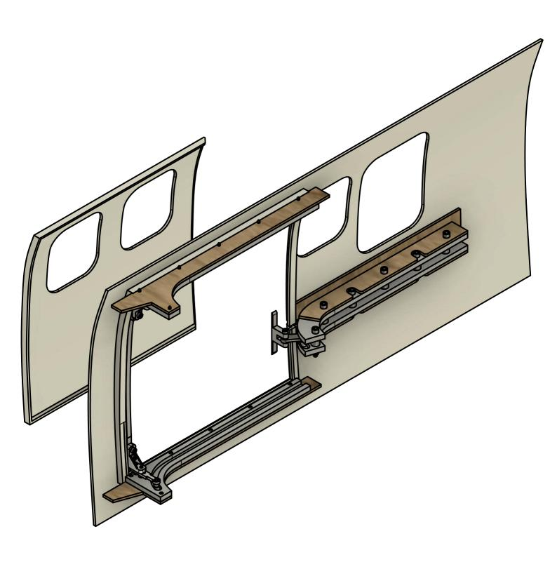
Das Türblatt mit Klebeband in die Aussparung am Rumpf befestigen. Die Einheit A in die untere und obere Kunststoff-Schiene einhängen, bis an den Anschlag schieben und rechtwinklig zum Türblatt ausrichten. Ggf die Schrauben Nr18 lösen und die Höhe und Tiefe nachjustieren. Dann mit Sekundenkleber fixieren.
