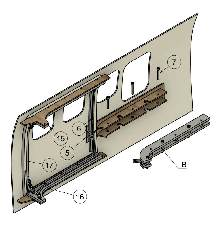
Die Schrauben Nr7 und Nr6 entfernen und die Einheit B herausziehen. Ebenfalls die beiden Kunststoffschienen Nr 15 und Nr16 wieder demontieren. Anschliessend alle Holzspanten und die Kunstoffprofile Nr 5 und Nr17 mit Uhu Endfest 300 einharzen.
