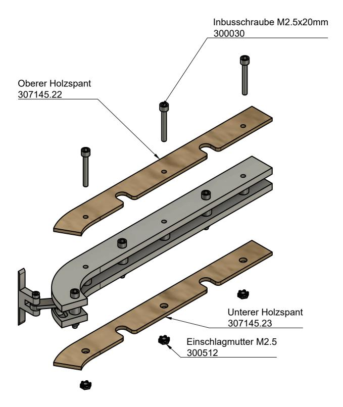
In den unteren Holzspant Nr 11 drei Einschlagmuttern einsetzen und z.B mit Uhu Endfest 300 festkleben.
