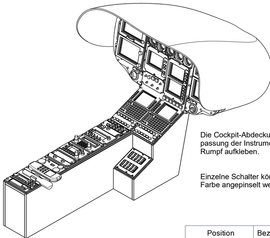
Die Cockpit-Abdeckung erst nach der Einpassung der Instrumenten-Konsole in den Rumpf aufkleben.
