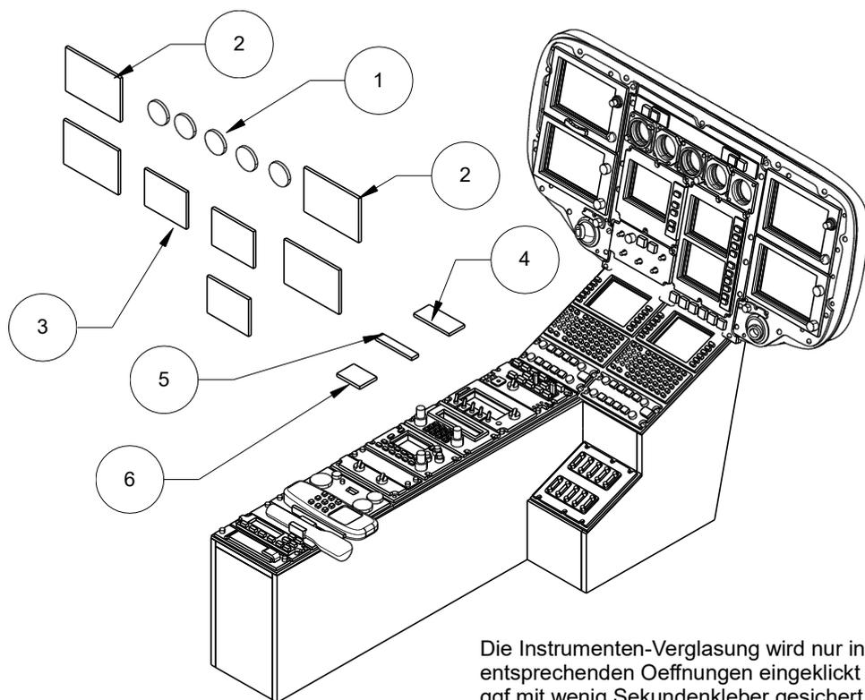
Die Instrumenten-Verglasung wird nur in die entsprechenden Oeffnungen eingeklickt und ggf mit wenig Sekundenkleber gesichert
