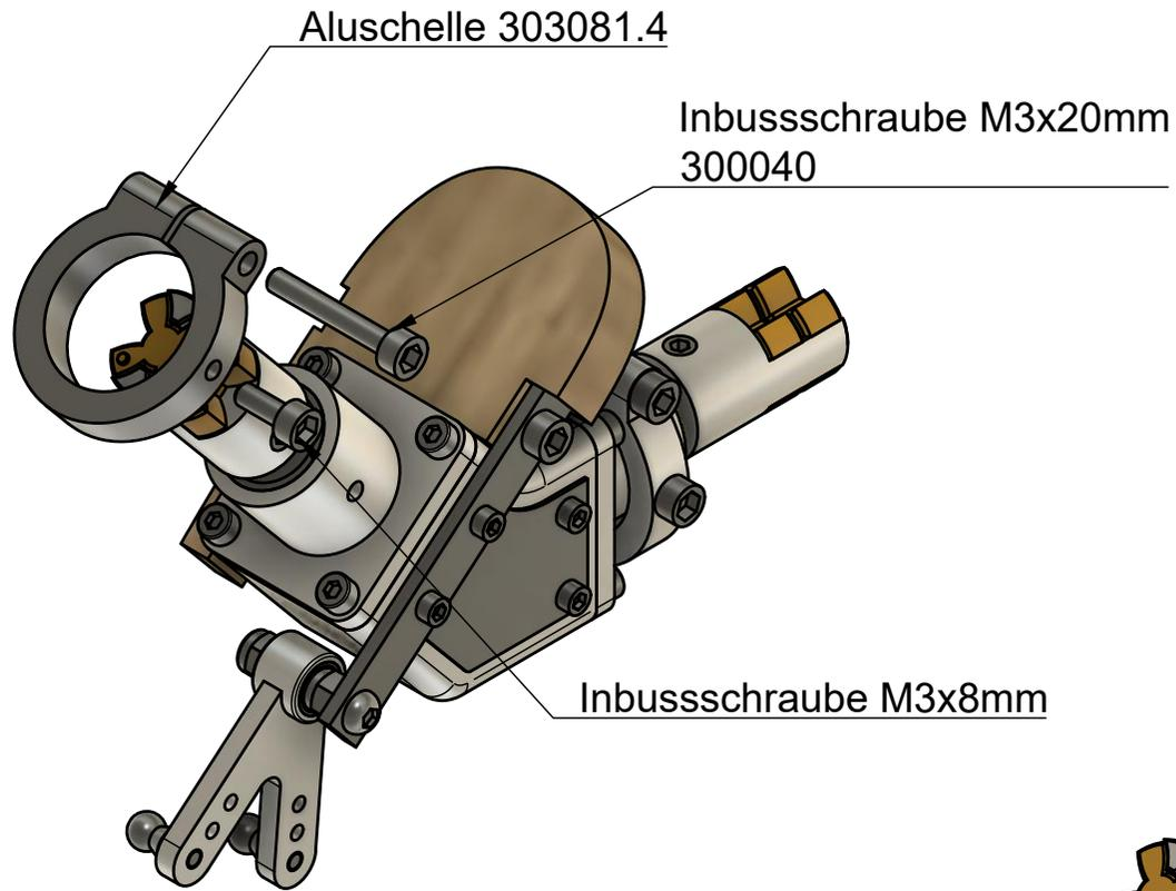
Mit der Aluschelle 303081.4 wird das Heckrohr auf das Winkelgetriebe befestigt
